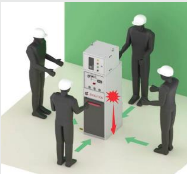
Сброс продуктов горения при дуговом замыкании вниз, в кабельный полуэтаж
